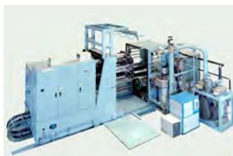
巻取式真空蒸着装置 EWシリーズ
