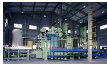
真空熱処理炉 FHHシリーズ
