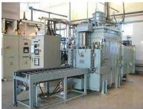
自動車部品用真空熱処理炉
