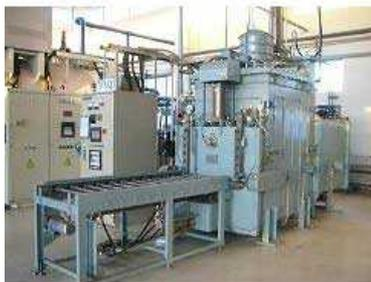
自動車部品用真空熱処理炉
