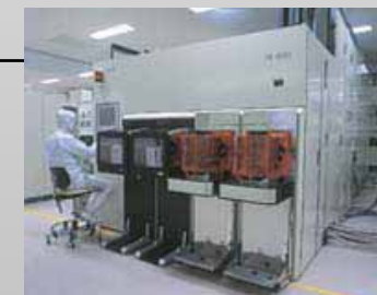
イオン注入装置
