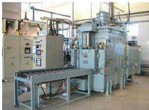
自動車部品用真空熱処理炉
