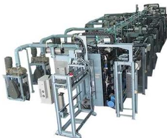
焼結処理・熱処理炉
