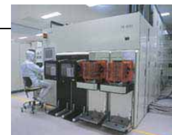
イオン注入装置
