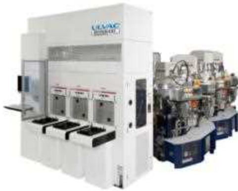
半導体製造装置 （スパッタリング装置）
