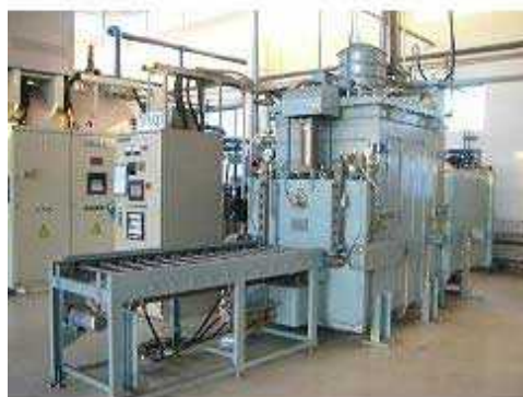
自動車部品用真空熱処理炉
